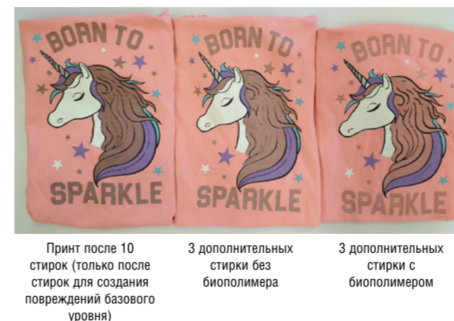
Рисунок 2: Повреждение термостойкого принта после 3-х дополнительных стирок по сравнению с исходным уровнем
